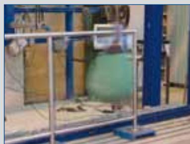
Prova di impatto sugli elementi di riempimento e sulla struttura con un corpo pesante 50 Kg avente un'energia di 150 Joule. Come previsto dalle normative.
