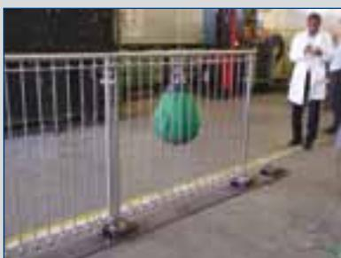
Prova dinamica d'urto: resistenza all'impatto di un corpo pesante 50 Kg sviluppando un'energia nel punto d'impatto di 150 Joule. Come previsto dalle normative.
