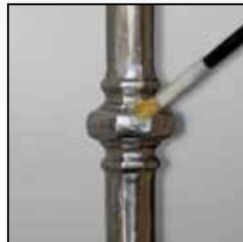
L'applicazione del Passivante E4052/P deve coprire interamente il componente
