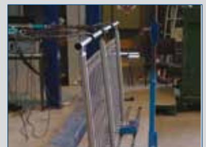
Prova statica di resistenza alla trazione al livello del corrimano con una forza centrale di 150 Kg e forze laterali di 75 Kg. Come previsto dalle normative.
