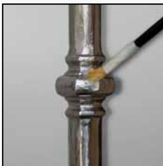
L'applicazione del Passivante E4052/P deve coprire interamente il componente Application of the passivating product E4052/P: the polluted component must entirely be covered
