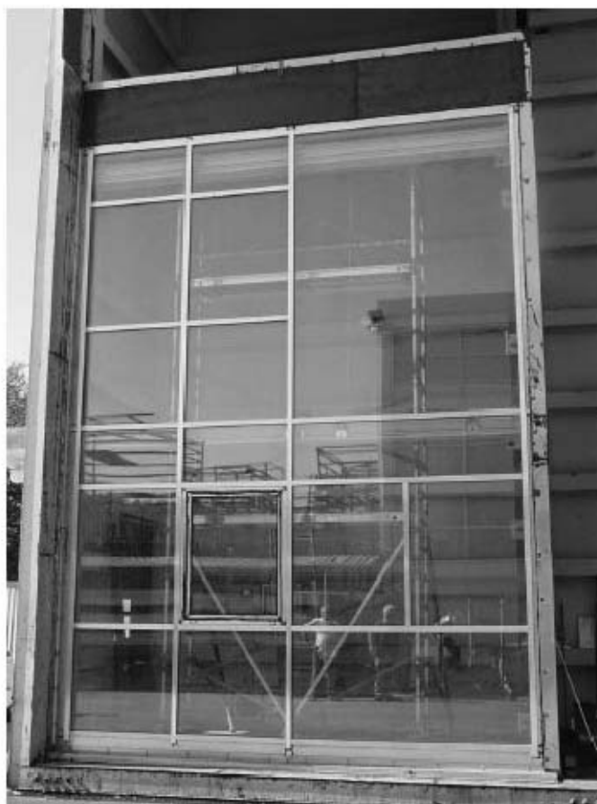
Bild 1 Fassade in Prüfstand eingebaut
