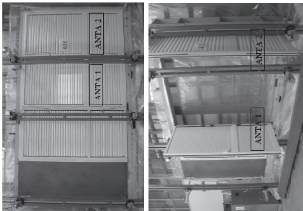
Foto 1 e 2. Campione sottoposto a prova nell'assetto sperimentale e dopo le prove di resistenza al carico del vento (carico di sicurezza diretto  $F_2$  e carico di sicurezza inverso  $F_3$ )
