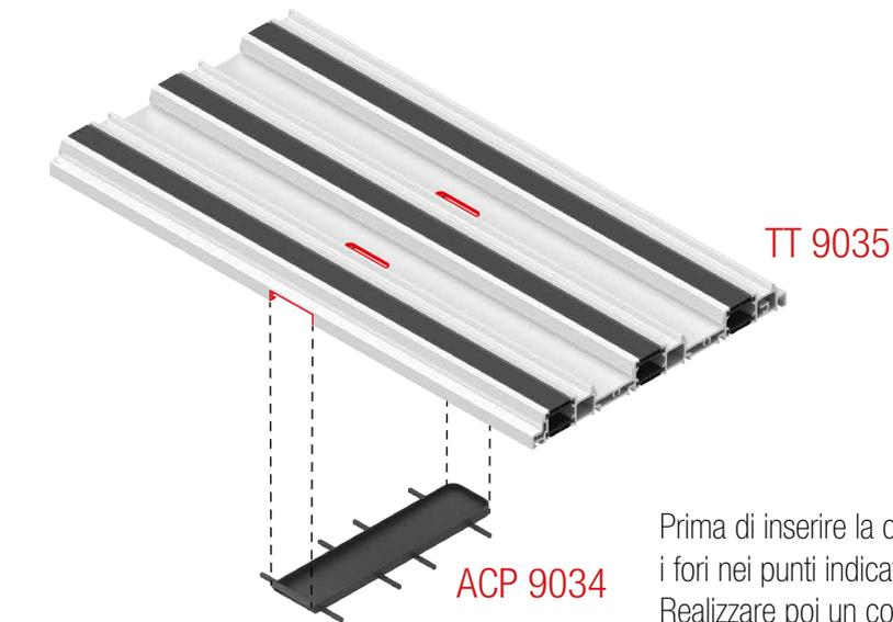
Prima di inserire la cappetta, chiudere i fori nei punti indicati da ambo i lati. Realizzare poi un cordolo di silicone su tutto il perimetro e solo dopo inserire la cappetta
