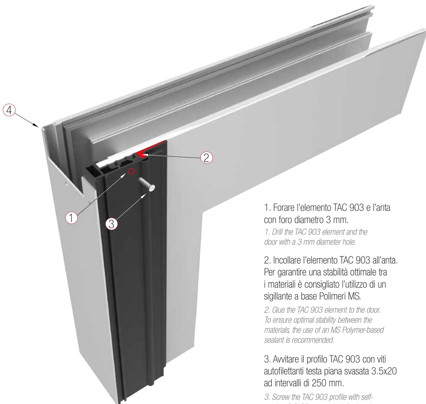
1. Forare l'elemento TAC 903 e l'anta con foro diametro 3 mm.
