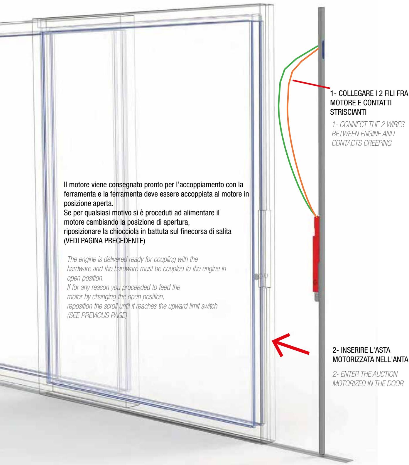
Il motore viene consegnato pronto per l'accoppiamento con la ferramenta e la ferramenta deve essere accoppiata al motore in posizione aperta.
