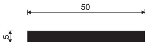
**STAFFA DI FISSAGGIO VZ 2232**Sez.: 2,50 cm<sup>2</sup>      Peso: 675 g/m $J_x = 0,05 \text{ cm}^4$        $W_x = 0,2 \text{ cm}^3$  $J_y = 5,2 \text{ cm}^4$        $W_y = 2,08 \text{ cm}^3$
