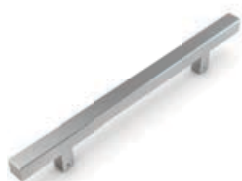
CO-131 Lunghezza: 460 mm Interasse: 300 mm Materiale: acciaio inox Finitura: cromo lucido
