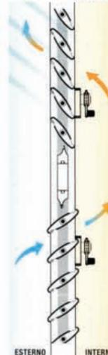
Il ribaltamento totale delle lamelle fino a 180° facilita il naturale ricambio dell'aria. Sfrutta i movimenti ascensionali e discensionali dell'aria stessa, smaltendo velocemente le varie forme di inquinamento soprattutto in alcuni ambienti come la cucina ed il bagno ed in locali con presenza di fumo o dove si svolge attività fisica.
