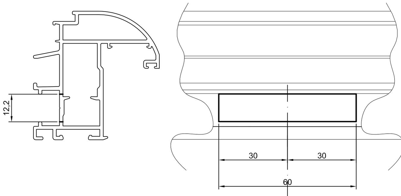
**lavorazione fori per fissaggio martellina, da effettuare manualmente**
