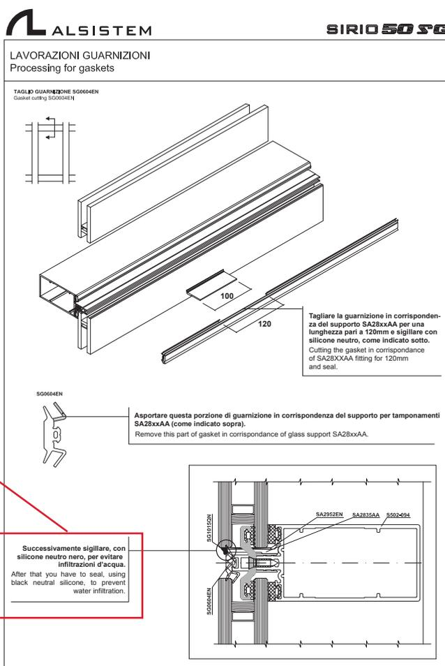
Sigillare con silicone neutro di colore nero per evitare infiltrazioni d'acqua
