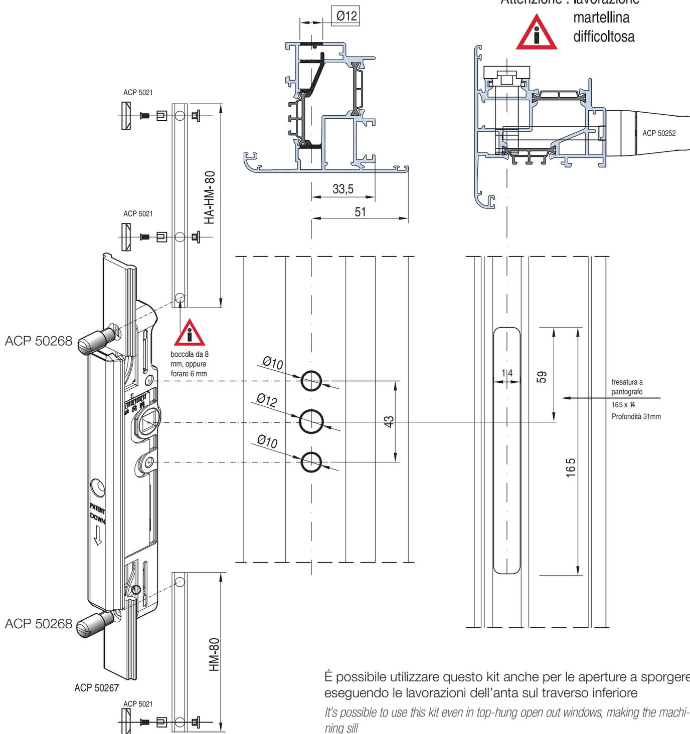
É possibile utilizzare questo kit anche per le aperture a sporgere eseguendo le lavorazioni dell'anta sul traverso inferiore
