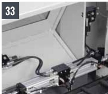
33 TIGER 372 CNC LR 4.0 / TIGER 402 CNC HR 4.0 - sistema di rotazione automatica della testa
