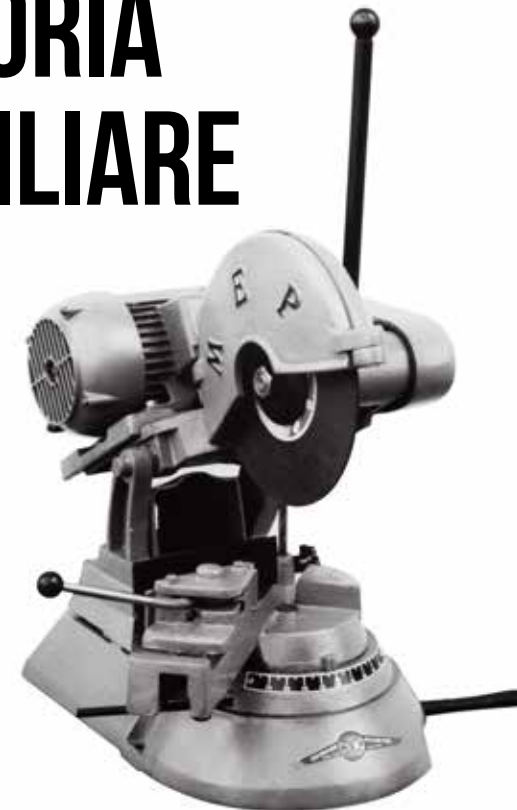
MEP TV 300 Il primo modello di troncatrice a disco abrasivo costruita in serie
