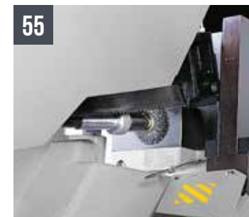
55 SHARK 332 SXI/NC 5.0 - 382 SXI Dispositivo pulilama a spazzola motorizzata
