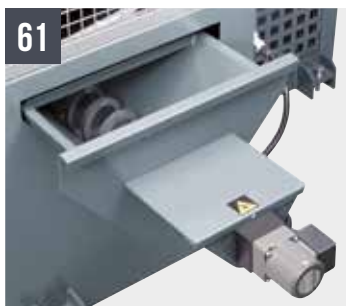
SHARK 230 NC 5.0 Evacuatore di trucioli motorizzato a coclea
