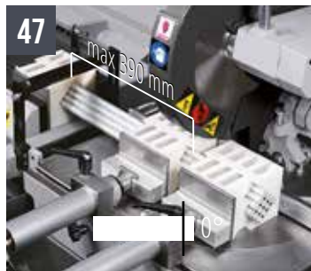
47 COBRA 352 NC 5.0 - serie di ganasce a pettine in nylon max 75x75
