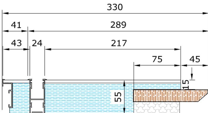
Spalle coibentata THERMO sp. 55 mm. da 280 mm con battuta variabile da 45 fino a 110 mm. e guida avvolgibile a doppia camera da 19 mm.
