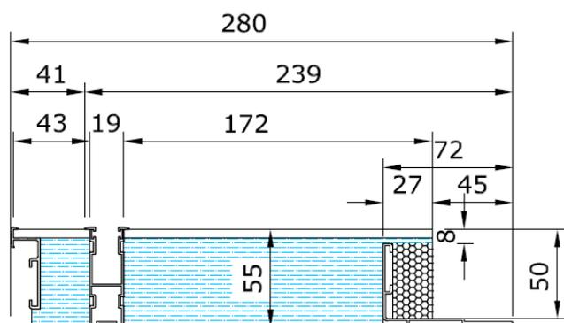
Spalle coibentata THERMO sp. 55 mm. da 330 mm con battuta variabile da 45 fino a 110 mm. e guida avvolgibile a doppia camera da 24 mm.
