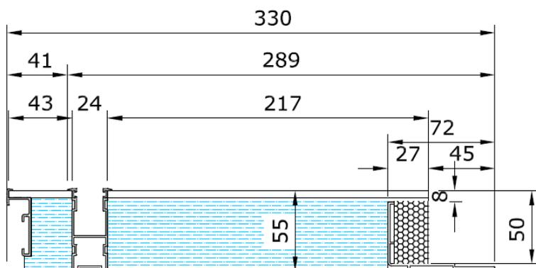
Spalle coibentata THERMO sp. 55 mm. da 280 mm con battuta variabile da 45 fino a 67 mm. e guida avvolgibile a doppia camera da 19 mm.
