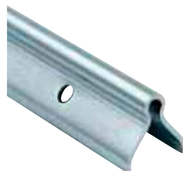
Guida inferiore per cancello a cementare D.19 SP.3 ML.6 zincata
