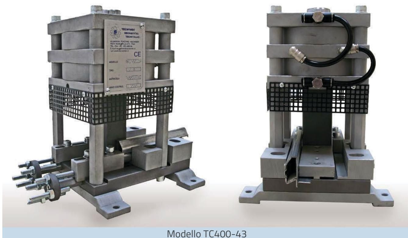
La punzonatrice **TC400-43** esegue la lavorazione di scantonatura, sia su profilo plastico che su profilo d'acciaio zincato, che consente la giunzione dell'angolo a 90 gradi
