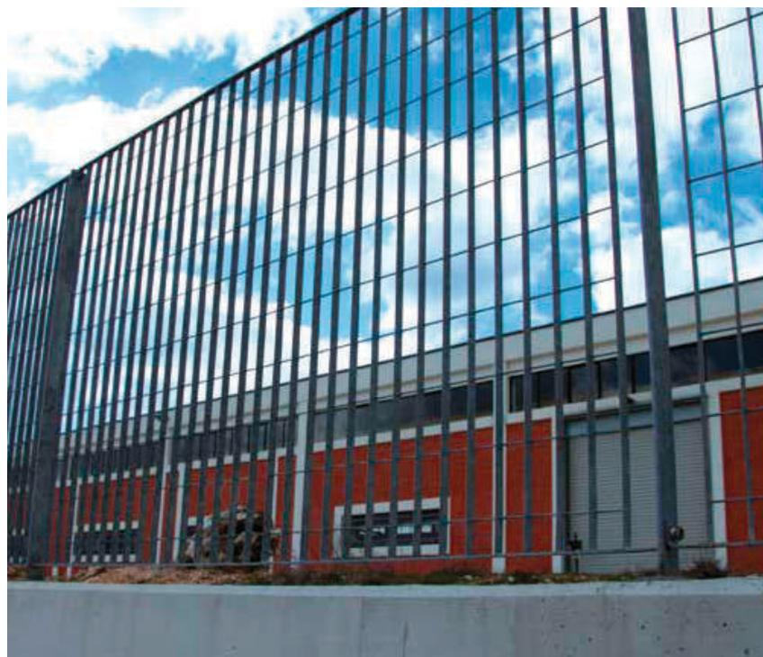
Recinzione in grigliato elettrofuso modello SVEVIA della EMMEGI® costituita da pannelli modulari, monolitici, non giuntati od affiancati larghezza mm 1992 o 1642, maglia mm 62x132, profili verticali in piatto mm 25x2 o 25x3 (interasse mm 62), collegamenti in tondo orizzontale Ø mm 5 (interasse mm 132).
