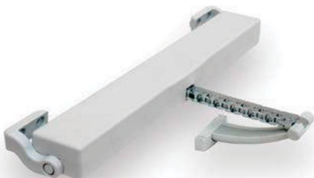
Attuatore elettromeccanico modello LIWIN L30 con catena articolata a doppia maglia e spessore maggiorato. Disponibile nelle versioni 230Vac e 24Vdc. Sistema di finecorsa elettrico in apertura e ad assorbimento di corrente in chiusura. Fino a 4 diverse corse facilmente regolabili mediante trimmer anche a motore non alimentato.
