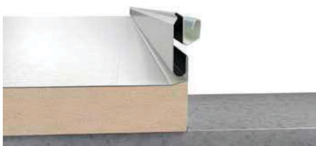
Fissaggio tramite staffa "fixing bracket" che permette lo scorrimento delle dilatazioni con possibilità di scelta tra fissaggio laterale o superiore. Con fissaggio superiore il pannello presenta uno scalino per contenere il bullone.
