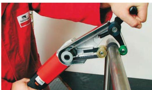
Per ripristinare la satinatura e asportare residui di saldatura all'interno di un angolo, possiamo utilizzare una smerigliatrice a nastro (UBC 10-R) con nastro abrasivo da 3 mm. che ci permette di smerigliare all'interno dell'angolo, e di andare a ripristinare la satinatura iniziale con un nastrino di Scotch Brite™.
