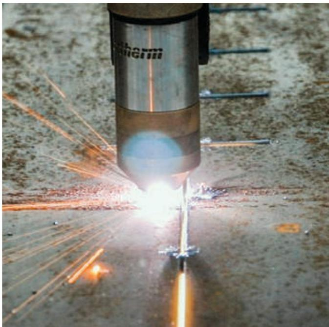
L'arco plasma fonde il metallo ed il gas, ad elevata velocità, rimuove il materiale fuso.
