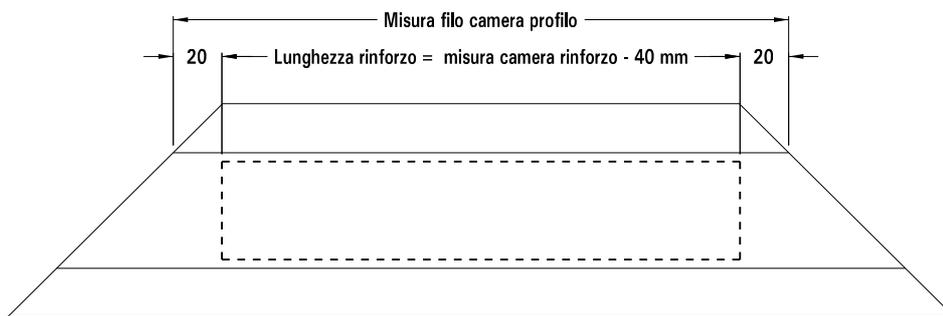
Lunghezza di taglio del rinforzo sul telaio e sul battente
