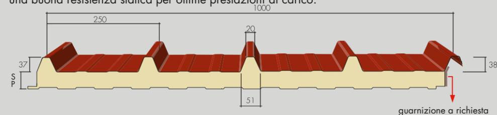
Micronervatura del lato INFERIORE del pannello (da specificare in fase d'ordine)
