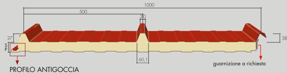
Micronervatura del lato INFERIORE del pannello (da specificare in fase d'ordine)
