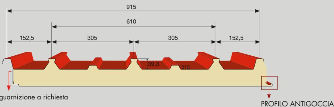
Micronervatura del lato INFERIORE del pannello (da specificare in fase d'ordine)
