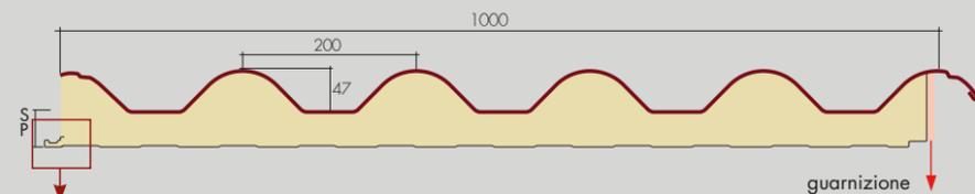
Micronervatura del lato INFERIORE del pannello (da specificare in fase d'ordine)
