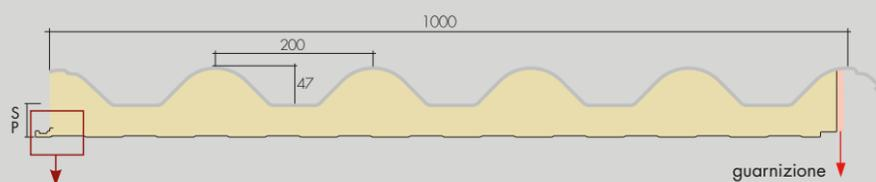
Micronervatura del lato INFERIORE del pannello (da specificare in fase d'ordine)
