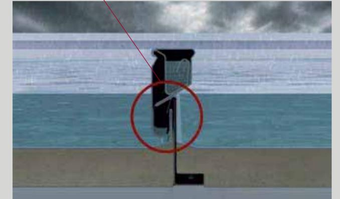
La pressione dell'acqua fa tenuta sulla greca. Persistendo la pioggia può filtrare per capillarità dell'acqua, la quale viene raccolta dal **PRIMO CANALE** di sicurezza.
