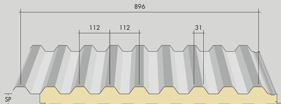
Micronervatura del lato INFERIORE del pannello (da specificare in fase d'ordine)
