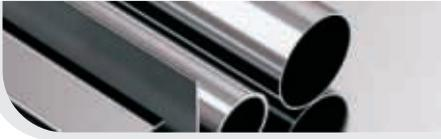
La satinatura è la lavorazione che rende la superficie del metallo brillante, tramite l'utilizzo di appositi abrasivi che incidono la superficie dell'acciaio inox.
